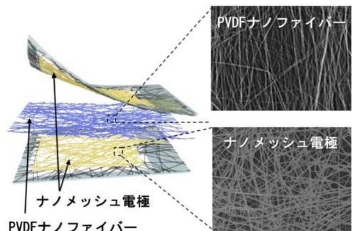
その結果、115dB の音源に対し、電力密度は  $8.2\text{W}/\text{m}^2$  という世界最高レベルを達成したとのこと。
