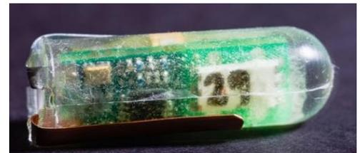
MITが開発した胃酸で発電するカプセル
