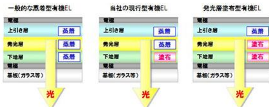
図 発光層塗布型有機 EL の構造 (文献 1) より)
