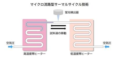
要がありますが、この処理に時間を要していました。そこで、異なる温度帯の複数のヒーターに接したマイクロ流路内で、測定試料を往復移動させるようにしました。これで、検査時間が $5\sim15$ 分に短縮できた
